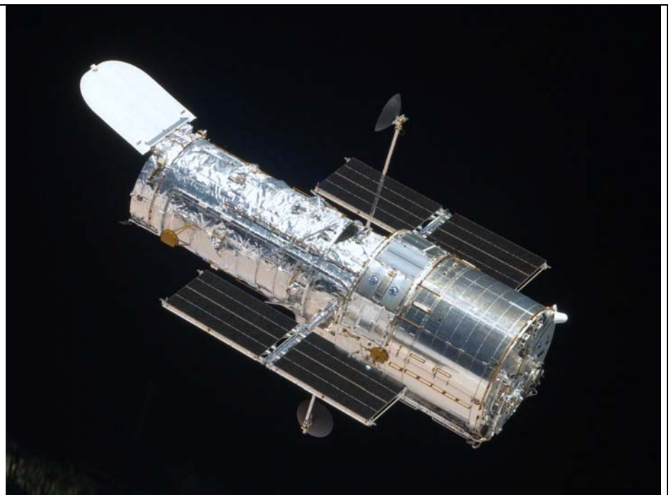
Abb. 12. Der berühmteste künstliche Mond der Erde, das Hubble-Weltraumteleskop, das nach dem amerikanischen Astronomen Edwin Hubble (1889-1953) benannt wurde; Start 1990 (13,1 m lang, 11,6 t Gewicht). Es umkreist die Erde in einer Höhe von 575 km in 96 Minuten.
